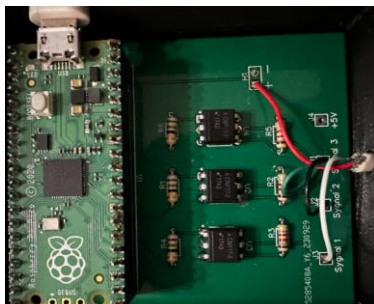
Rysunek 3 Rzeczywisty widok wykonanego sterownika znaczników
